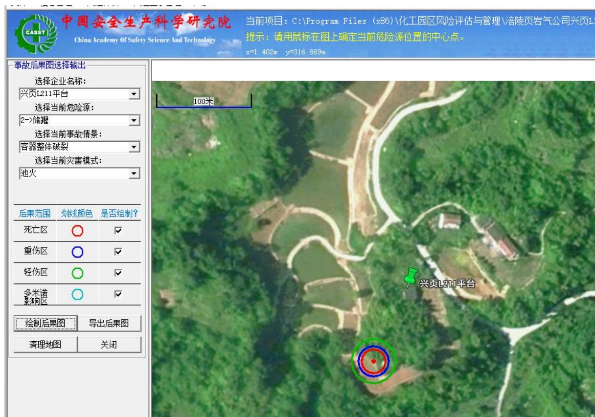
图 5.5-2 兴页 L211 平台原油储罐原油泄漏后果图
